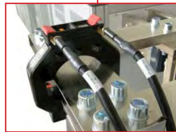
Detailansicht eines Prüflings (CT) sekundärseitig angeschlossen.
