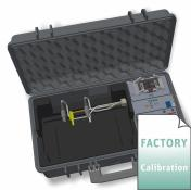
**EMOB80 Prüfkoffer für die Vor-Ort-Prüfung von AC-Ladesäulen**
