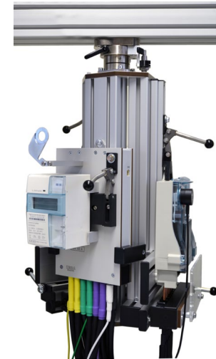
Drehbare Zählerkreuze Zählerkreuze für zwei oder drei Anschlussmöglichkeiten Schnelle, sichere Positionierung unterschiedlicher Zählertypen
