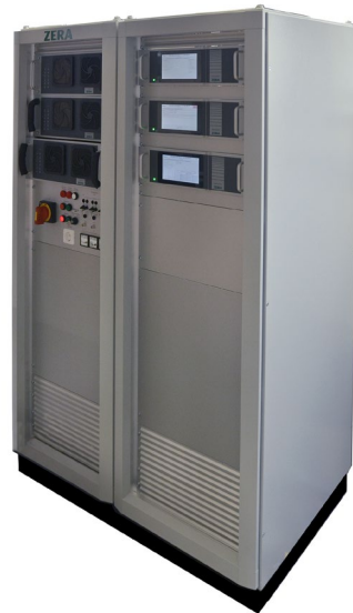
RPE04 Konstantstromquelle max. 4 kVA, 50 Hz, netzsynchron
