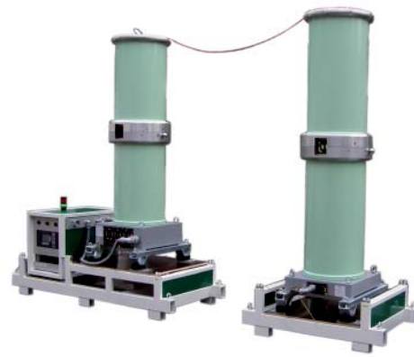
Aufbau zur Hochspannungsprüfung
