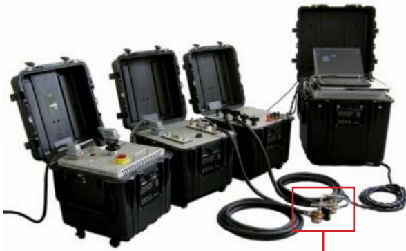
Detail der Strommesswandlerprüfung
