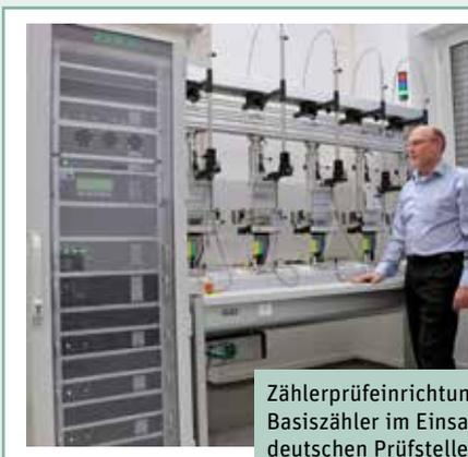
Zählerprüfeinrichtung für MS 2020 Basiszähler im Einsatz bei einer deutschen Prüfstelle
