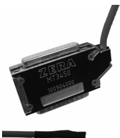
Temperatursensor MT3450 Temperatursensor zur Erfassung der Umgebungstemperatur an einer Messstelle. Der gemessene Temperaturwert wird im MT Messgerät angezeigt und abgespeichert. Temperaturbereich: -20° C... + 60° C (± 1° C) Auflösung: 0,1° C Kabellänge: 3 m
