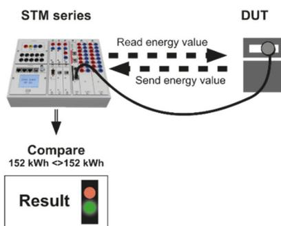
L'objectif d'un test de fonctionnement est de garantir l'exécution correcte d'une fonction ou d'un processus de communication. Par exemple, une valeur prédéfinie est interrogée, la réponse correspondante est comparée à la valeur attendue, puis évaluée (bonne ou mauvaise).
