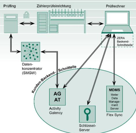
Une connexion réussie à l'objet testé protégé<sup>3</sup> est nécessaire pour la communication entre le dispositif de test de compteurs et le compteur. Les informations sur les clés et les mots de passe doivent être fournis au moment du contrôle. Dans ce cas, le traitement manuel par l'examineur est inapproprié.
