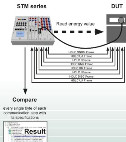
L'objectif d'une analyse de communication est d'examiner en détail la communication de l'objet testé et de s'assurer que chaque octet transmis est conforme aux spécifications. Contrairement au test de fonctionnement, ce contrôle n'est pas axé sur l'évaluation du contenu à transmettre, mais sur la *conformité au processus systématique de communication*.
