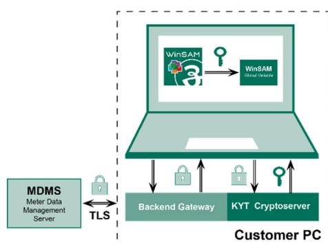
La gestion des clés a pour tâche de gérer les clés nécessaires aux processus de cryptage (également : procédures cryptographiques<sup>1</sup>).
