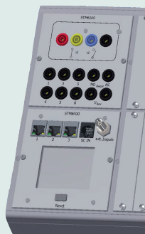
Display module plus test voltage switch module
