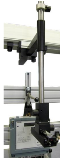
Tastkopf-Standardaufhängung Kugelgelagerte Aufhängung mit Schnellhöhenverstellung und Feinjustierung
