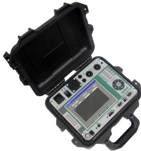
MT680s einphasiges Prüfsystem Klasse 0.1 120 A
