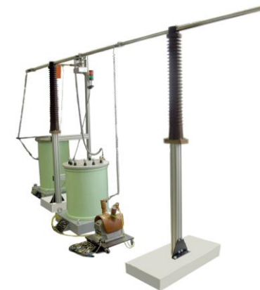
ITTS (CT-VT-80) CT-VT-Prüfsystem Erzeugung: max. 80 kVA
